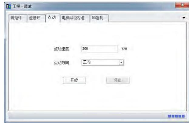
选择点动的转速和方向,点击开始,确认电机正确旋转。
