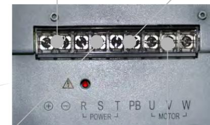
主回路、控制回路电源输入
