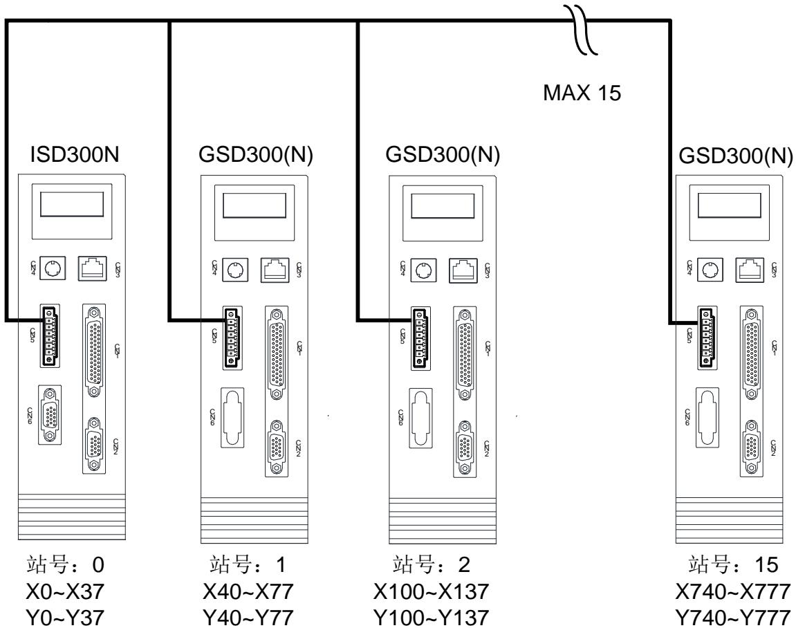
主站使用 ISD300/MSD300/ISD300N 系列伺服驱动器，具有可编程功能，主站程序可以通过 DBUS 总线，管理各从站的空闲 I/O 点。
