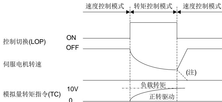
注. 在切换到速度控制的同时将启动信号(ST1, ST2)置 OFF，伺服驱动器将按照设定的减速时间常数减速停止。
