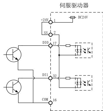
(DI接线, 漏型方式输入, 内部电源)
