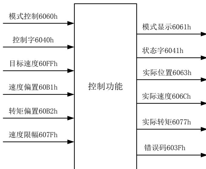
注意：速度限制由 607F 和电机最大转速中的较小值决定。
