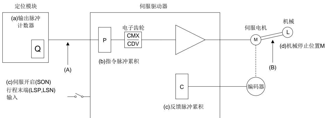
在产生位置偏差时，检查上图中的(a)输出脉冲计数器，(b)指令脉冲累积显示，(c)反馈脉冲累积显示和(d)机械停止位置。此外，(A)(B)是引起位置偏差的主要原因。例如(A)表示定位装置和伺服驱动器的接线中由于受到噪声的影响而引起脉冲计数错误。
