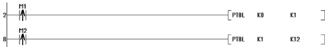
在 PLC 程序中使用 PTBL 指令使能表格指令，其中第一个参数指定轴号，第二个参数指定表格指令编号，如 PTBL K1 K12 表示启动 1 轴的编号 12 的定位指令。
