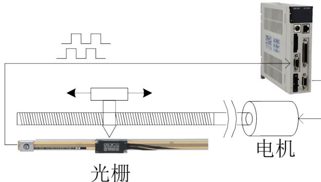
驱动器必须处于定位模式，全闭环编码器为 AB 相增量编码器，其 AB 相信号接入驱动器 CN6 接口，信号连接关系为：
