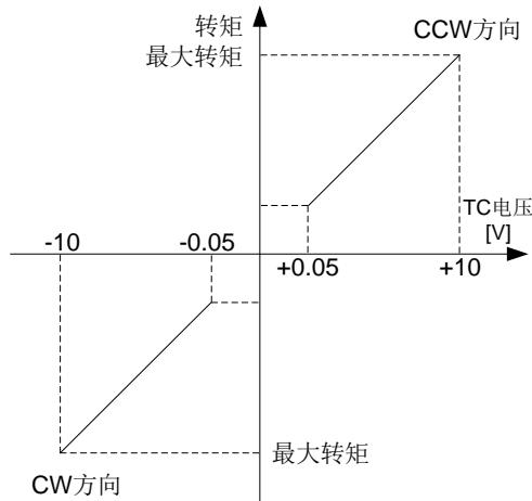
相对一定电压所产生的输出转矩值，由于产品的不同有约 5% 的偏差。
