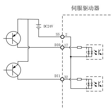
(DI接线, 源型方式输入, 外部电源)
