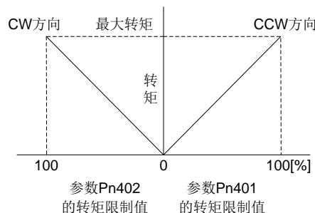
模拟量转矩限制(TLA)的输入电压和伺服电机转矩的限制值的关系如下所示。相对一定电压所产生的输出转矩限制值，由于产品的不同有约 5% 的偏差。另外，输入电压在 0.05V 以下时无法充分限制输出转矩，转矩可能产生变动，所以请在 0.05V 以上的电压时使用。
