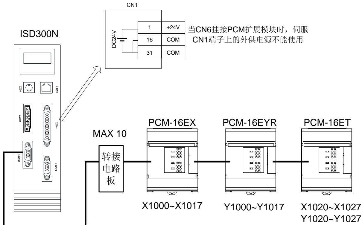
通过 IBUS 扩展的 I/O 点, 也采用八进制编码方案, 从 X1000 和 Y1000 开始向后排列。例如, 图中 PCM-16EX 占用 X1000~X1017, PCM-16EYR 占用 Y1000~Y1017, PCM-16ET 占用 X1020~X1027 和 Y1020~Y1027。
