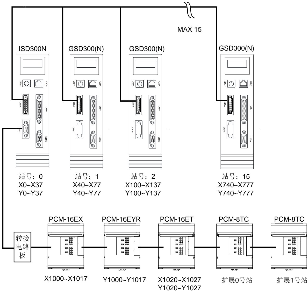
伺服驱动器对 IBUS 上接入的扩展模块可以自动辨识，自动顺序编址，无需用户干预。自动编址操作在上电正常后即进行一次，此后运行中各扩展模块的地址保持不变。在伺服驱动器运行期间，不可将扩展模块接入或拔掉，以免损坏伺服驱动器，或导致运行异常。
