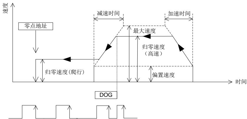
机械归零通过 Pn827 的 Bit6 的上升沿启动。在以归零速度(高速)按照归零方向移动后，当检测到工件到达 PG\_DG 端子后减至归零速度(爬行)，同时开始对零点信号计数，当计数到指定的数量后工件停止，并将零点地址(Pn814-Pn815)传递给当前地址(Pn829-Pn830)，置归零完成标志。PG\_DG 搜索按照下面的曲线动作，遇到正向极限或反向极限时，可自动反方向运行，如下图箭头所示。
