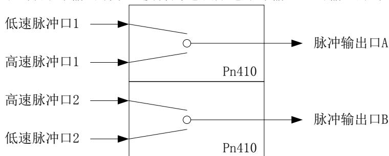
当 Pn410=0 时，输出低速脉冲口接收到的脉冲，当 Pn410=1 时，输出高速脉冲口接收到的脉冲。
