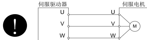
② 供给伺服驱动器的电源不要和伺服电机动力端子(U, V, W)连接。否则伺服驱动器和伺服电机会发生故障。
