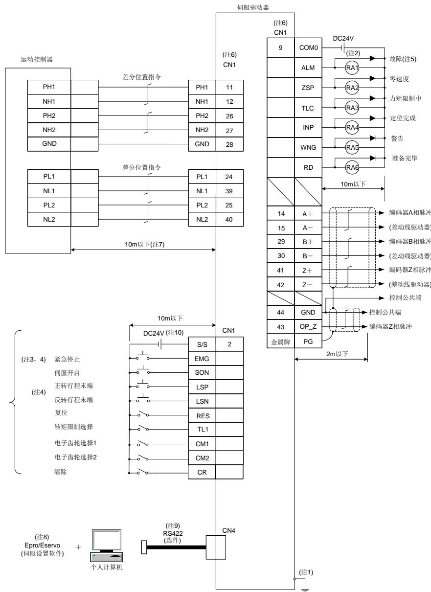
1. 为防止触电，必须将伺服驱动器保护接地(PE)端子（有标记）连接到控制柜的保护地端子(PE)上。
