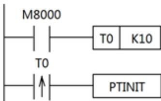
在 ISD300N 的 PLC 程序中初始化运动控制表格。
