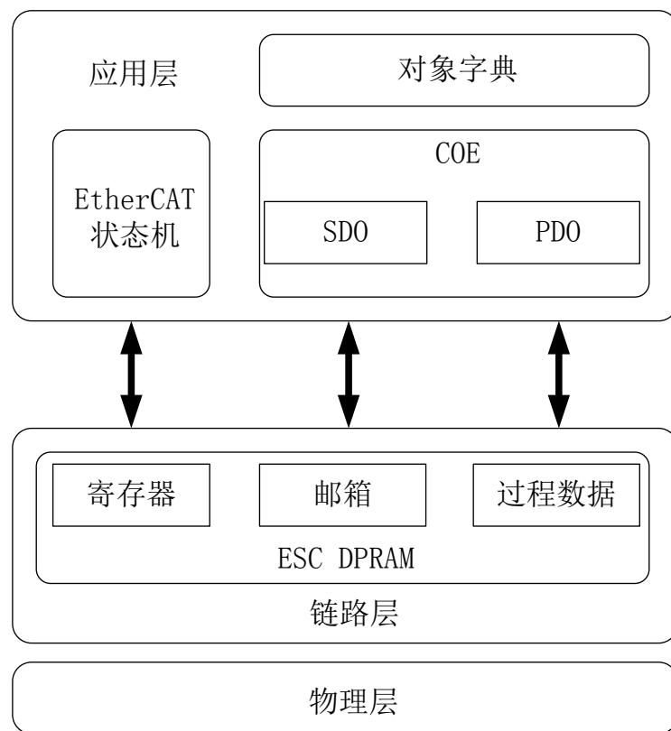
图 6-3 基于 CANOpen 应用层的 EtherCAT 通信结构
