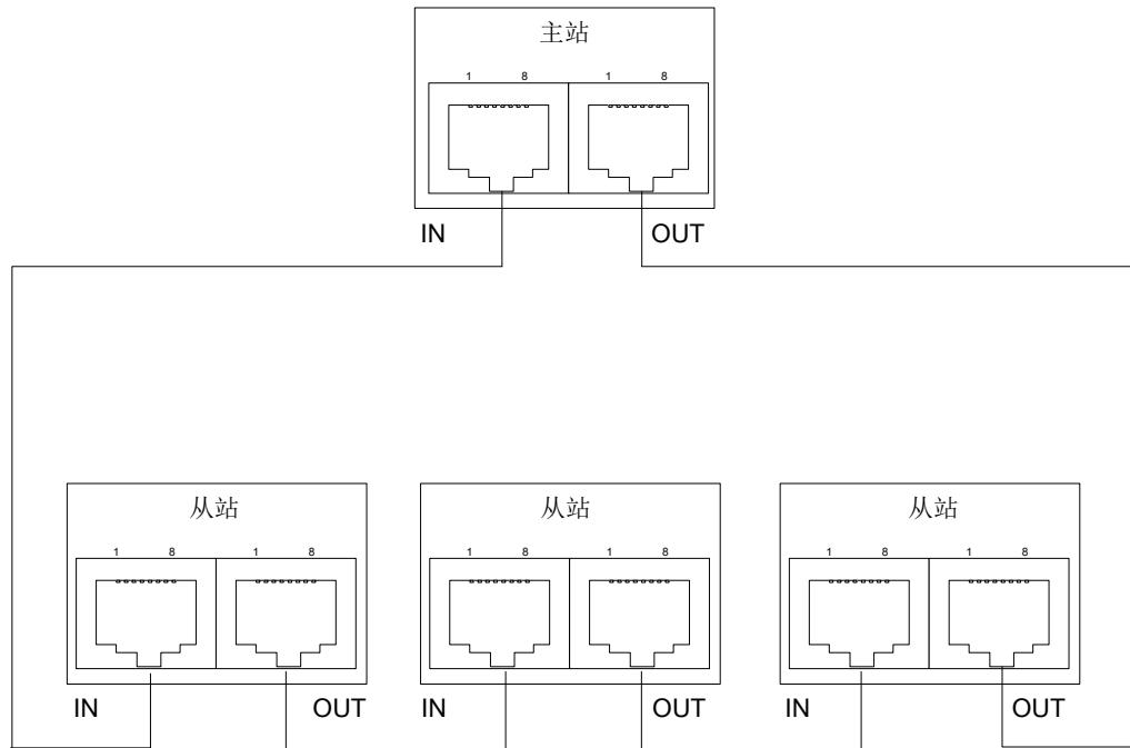
注意: EtherCAT 通信线缆使用的是 Ethernet Category 5(100BASE-TX) 网络线或者高强度的带屏蔽的网络线。在使用本伺服驱动器时，也需要使用带屏蔽的网络线，长度不超 100M。屏蔽网络线会增强系统的抗干扰能力。
