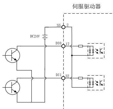
(DI接线, 漏型方式输入, 外部电源)
