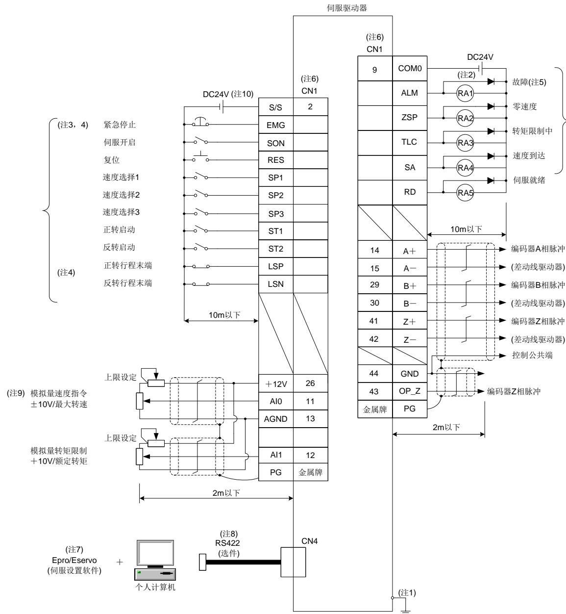
1. 为防止触电，必须将伺服驱动器保护接地(PE)端子（有标记）连接到控制柜的保护地端子(PE)上。
