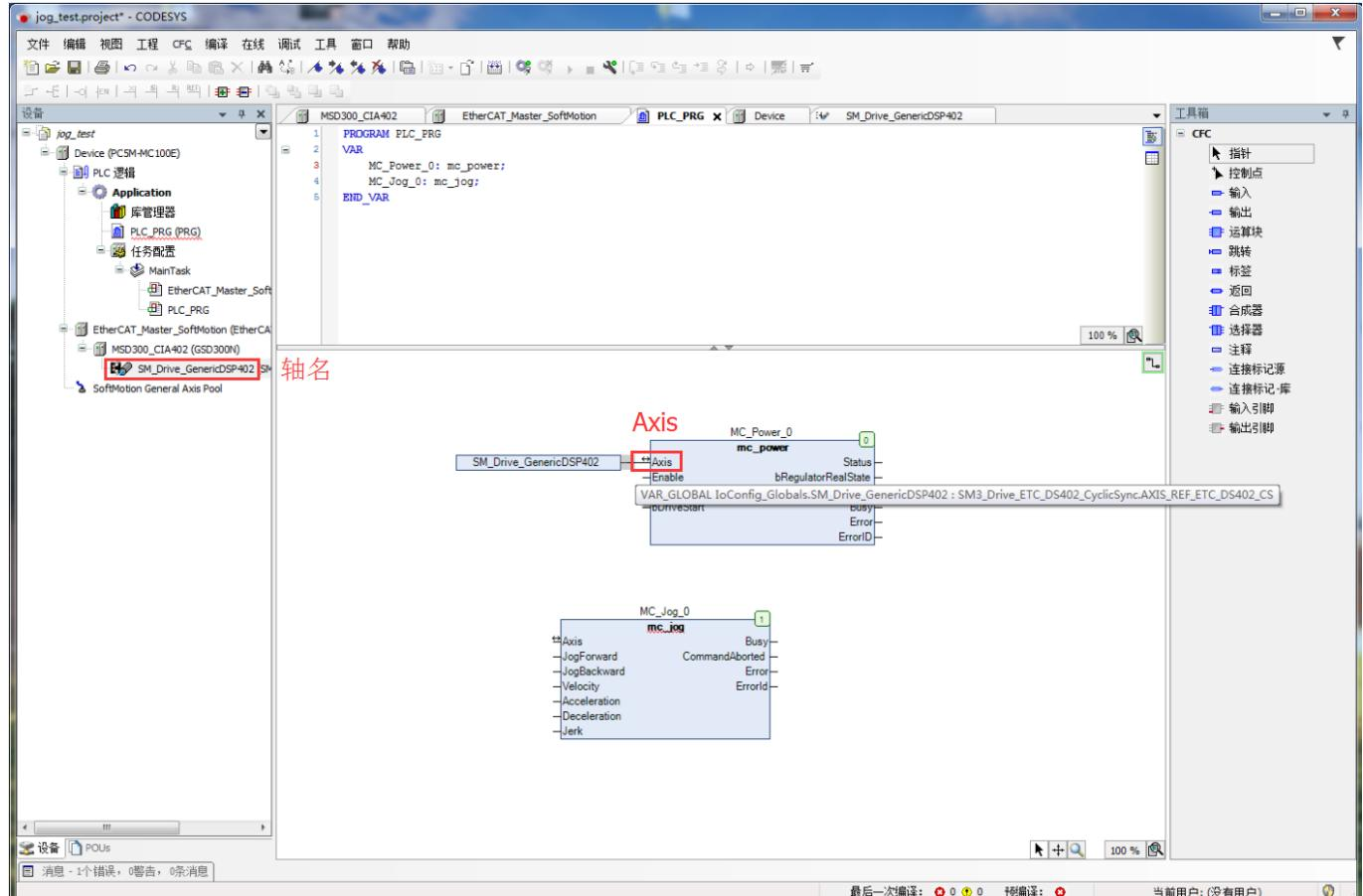
13) 逐一单击“mc\_power”其余的输入/输出端口并键入信号（变量）的名字，名字可以自己定义。
