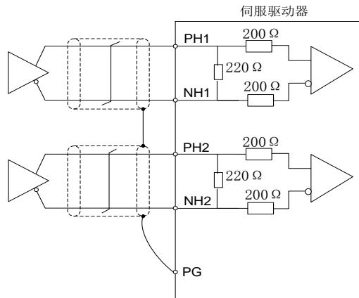
以输入波形设定为负逻辑，正转脉冲串/反转脉冲串(将参数 Pn411 设定为 4)举例进行说明。
