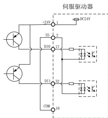
(DI接线, 源型方式输入, 内部电源)
