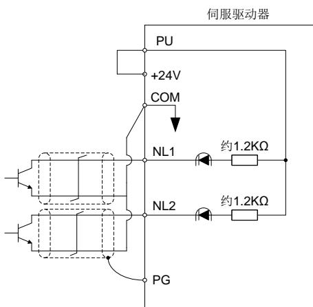
以输入波形设定为负逻辑，正转脉冲串/反转脉冲串（将参数 Pn411 设定为 4）举例进行说明。晶体管 ON/OFF 关系如下所示：
