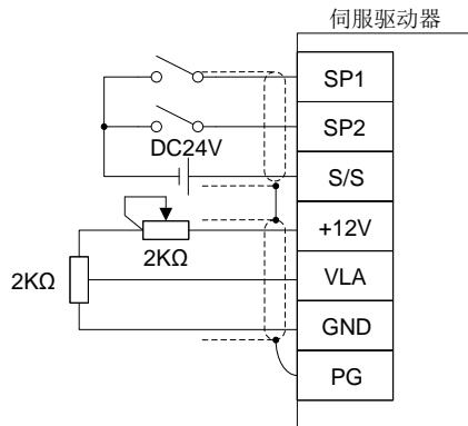
(b)速度选择 1(SP1)/速度选择 2(SP2)/速度选择 3(SP3)和速度限制值使用速度选择 1(SP1)、速度选择 2(SP2)和速度选择 3(SP3)选择内部速度限制 1-7 设定的转动速度和速度限制指令(VLA)设定的转动速度,如下所示。
