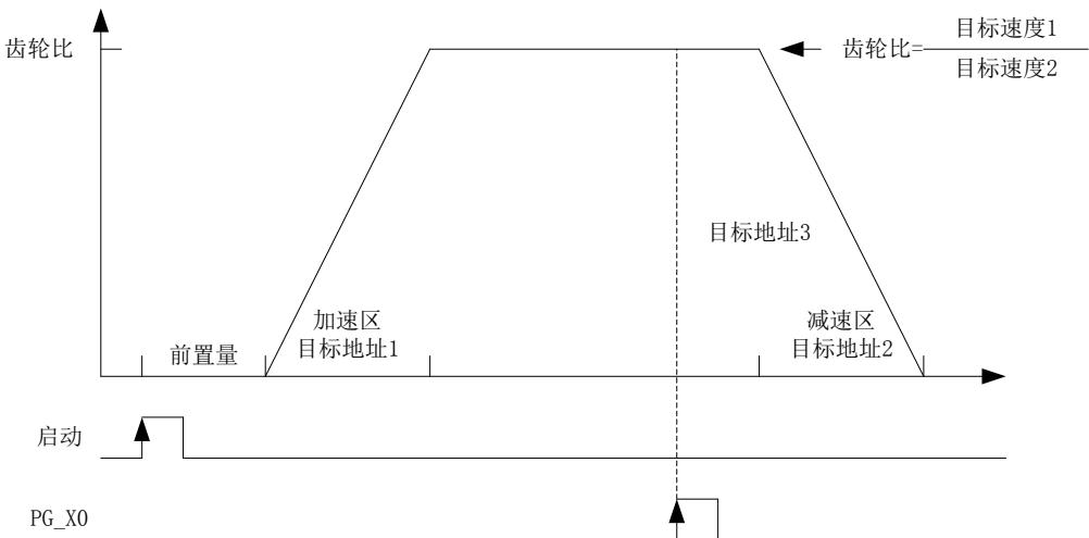
启动后，先进入前置区，此时电机不运行，越过前置区后电机加速到与主轴同步，遇到中断信号 PG\_X0 后以目标地址 3 减速停止。
