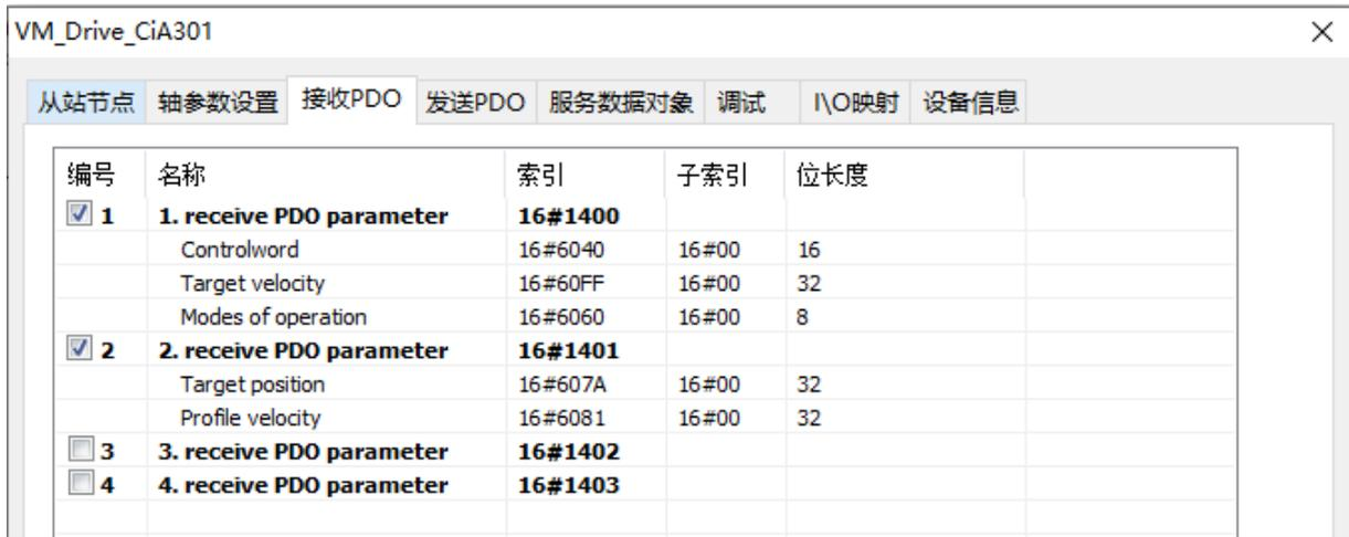
PDO 通信推荐使用同步方式，从站同步 PDO 通信设置方式如下：
