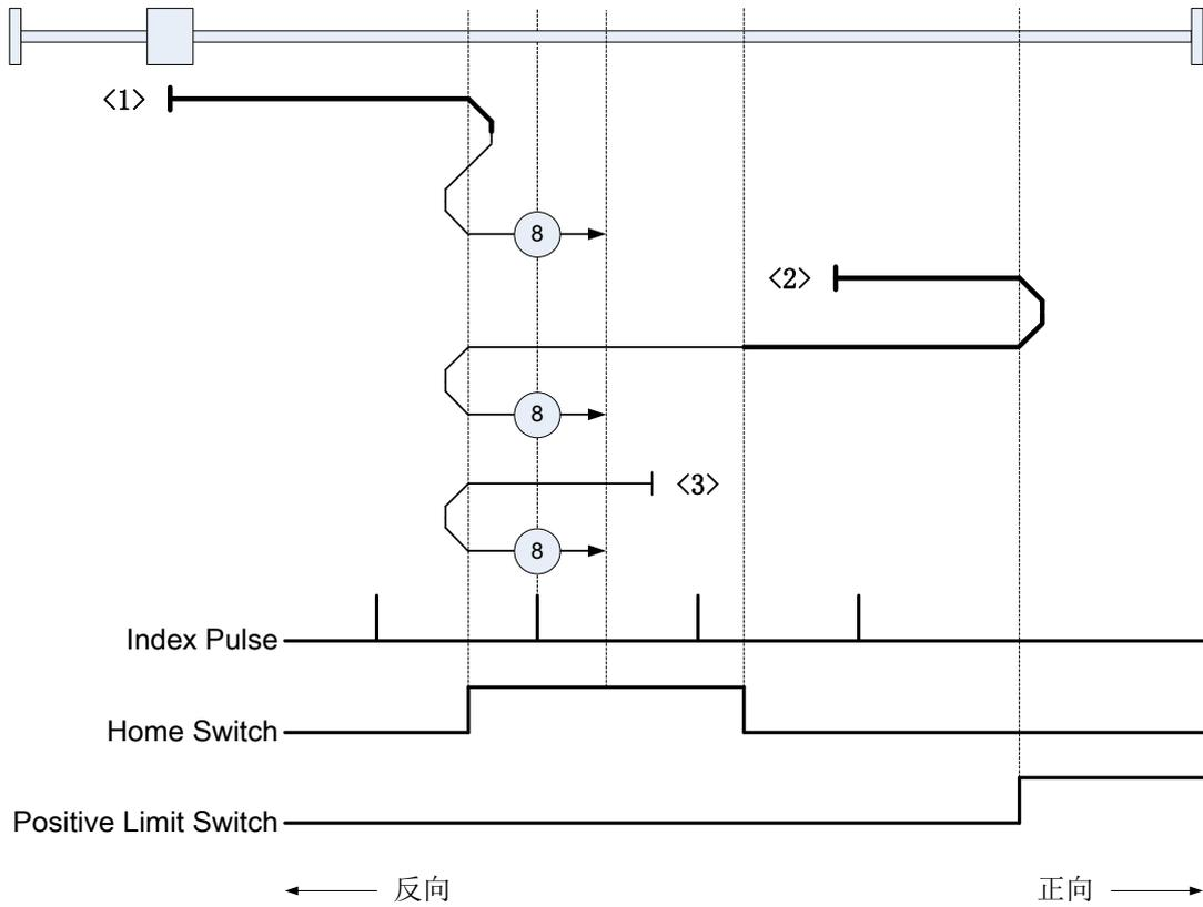
注：索引脉冲信号 (IP) 由伺服内部检测编码器零点位置产生。
