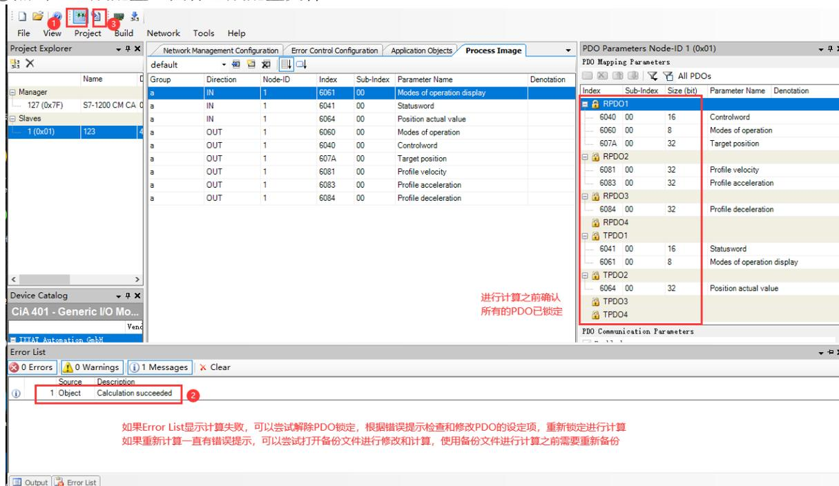
计算完成后在 Process Image 界面下可以显示从站对象在 CM 模块内存区中的地址分配，图中的 Address 和 Size 两项是 TIA 软件对 CM 进行硬件组态时的输入输出数据大小：
