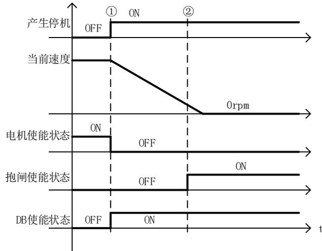
(6) 非抱闸，零速停机、减速停机或转矩限制的零速停机，停机后保持 DB 状态的逻辑时序如图所示。
