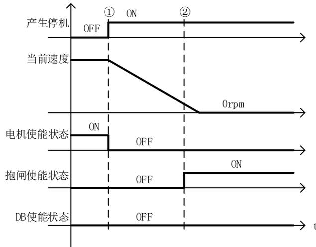
(2) 非抱闸，DB 停机，停机后保持自由状态的逻辑时序如图所示。
