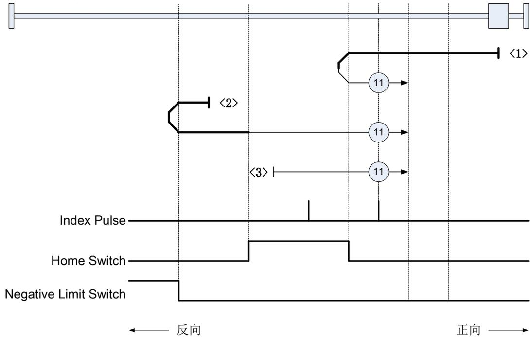
注：索引脉冲信号 (IP) 由伺服内部检测编码器零点位置产生。
