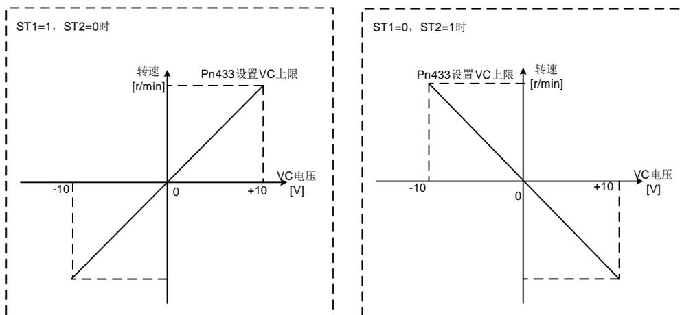
由正转启动信号(ST1)和反转启动信号(ST2)控制旋转方向如下表所示。
