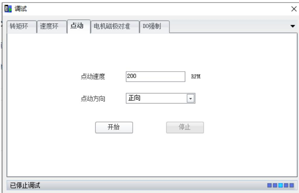
设定好点动速度和方向，点击“开始”可以启动电机。
