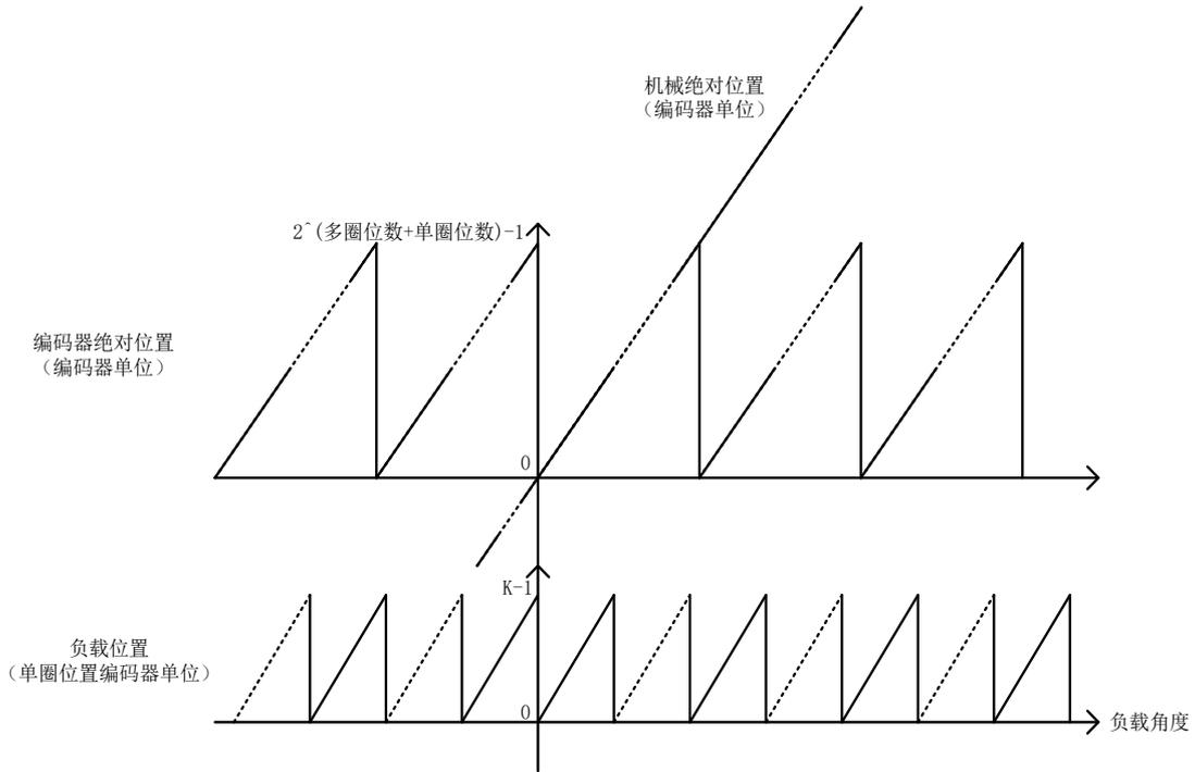
绝对位置旋转模式控制 (pn492) 的 bit0-bit2 为绝对位置旋转模式选择, bit3 为通讯使能伺服时是否禁止补偿, 该补偿使通讯使能伺服时编码器位置自动旋转对齐到用户单位目标位置。如图所示, 假设绝对位置旋转模式用户电子齿轮比 (pn482-485) 分子为旋转负载一圈的脉冲数, 分母为 10, 通讯使能伺服时, 伺服使能锁定的当前目标位置与用户单位的期望位置可能存在偏差, 通过补偿后使伺服使能锁定的当前目标位置旋转到与期望位置重合。
