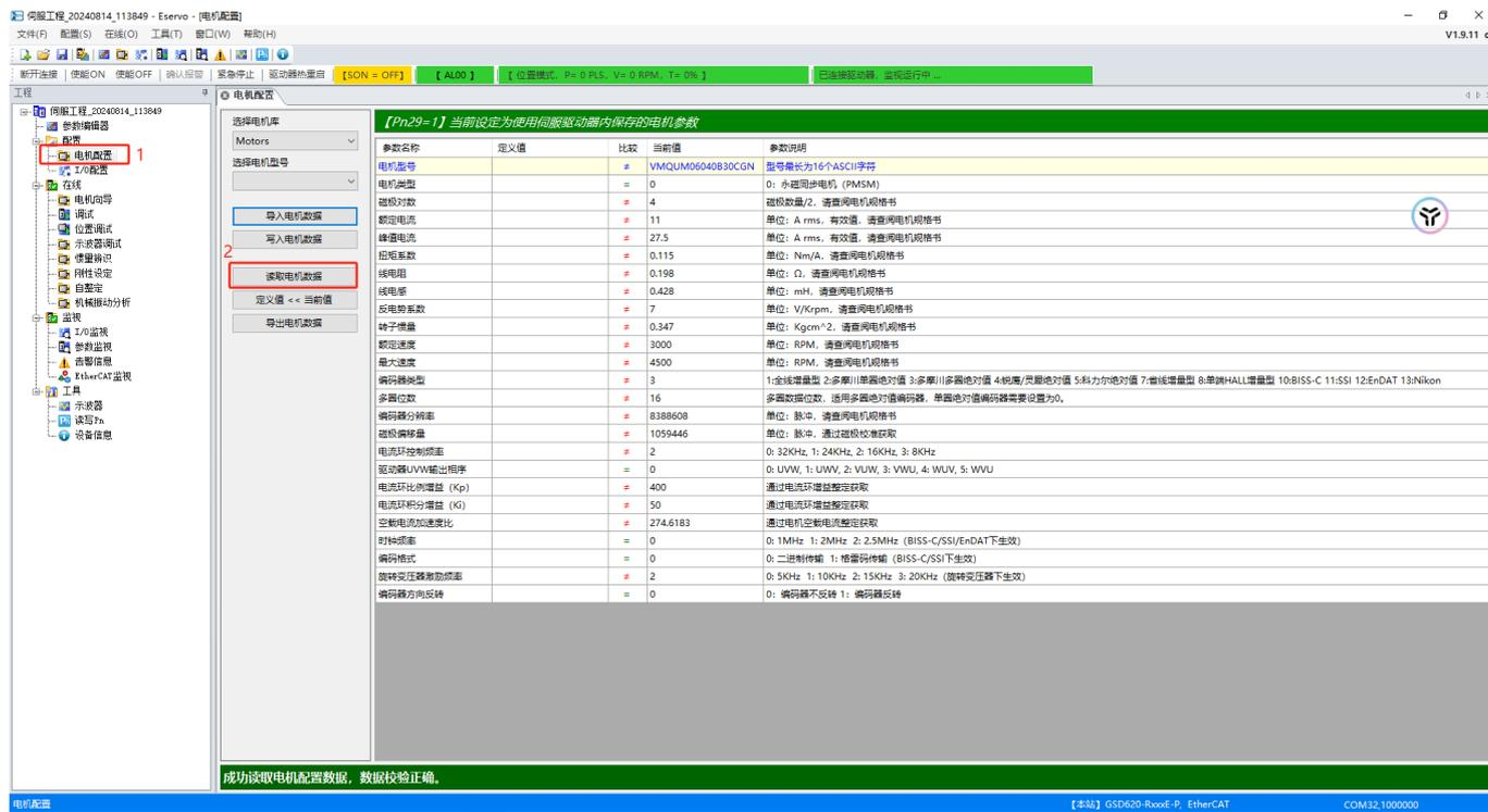
如果读取预置文件失败，驱动器将报警 AL03，提示为电机参数加载错误。请和本产品供应商确认电机是否在本品原厂匹配并预置过电机库文件。
