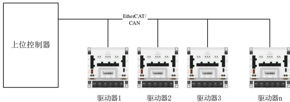
在复杂系统应用中，620 系列低压伺服驱动器具备 CANopen、EtherCAT 以及 MODBUS 总线功能，轻松应对不同的应用场合。
