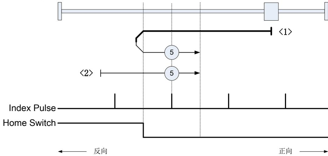
注：索引脉冲信号 (IP) 由伺服内部检测编码器零点位置产生。
