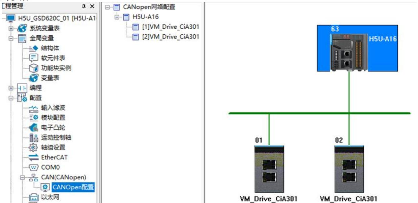
H5U 轴控指令通过 PDO 通信方式控制驱动器，GSD620 CAN 和 H5U 搭配使用时 PDO 默认采用同步方式，因此在本界面需要勾选“使能同步生产”选项，并根据需求设置同步周期（一般 8 个轴设置为 15ms 即可）。
