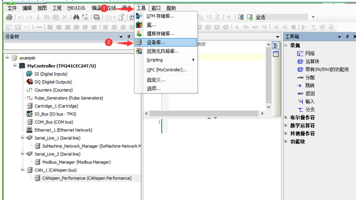
2) 点击弹出的“设备库”窗口的“安装”按钮，在弹出的窗口中选择设备 EDS 存放位置，打开 EDS 文件(如果 EDS 文件已经导入，下述步骤可以省略)。
