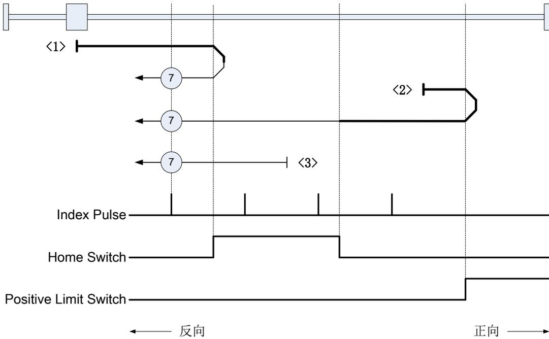
注：索引脉冲信号（IP）由伺服内部检测编码器零点位置产生。
