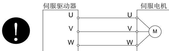
② 供给伺服驱动器的电源不要和伺服电机电力端子(U, V, W)连接。否则伺服驱动器和伺服电机会发生故障。
