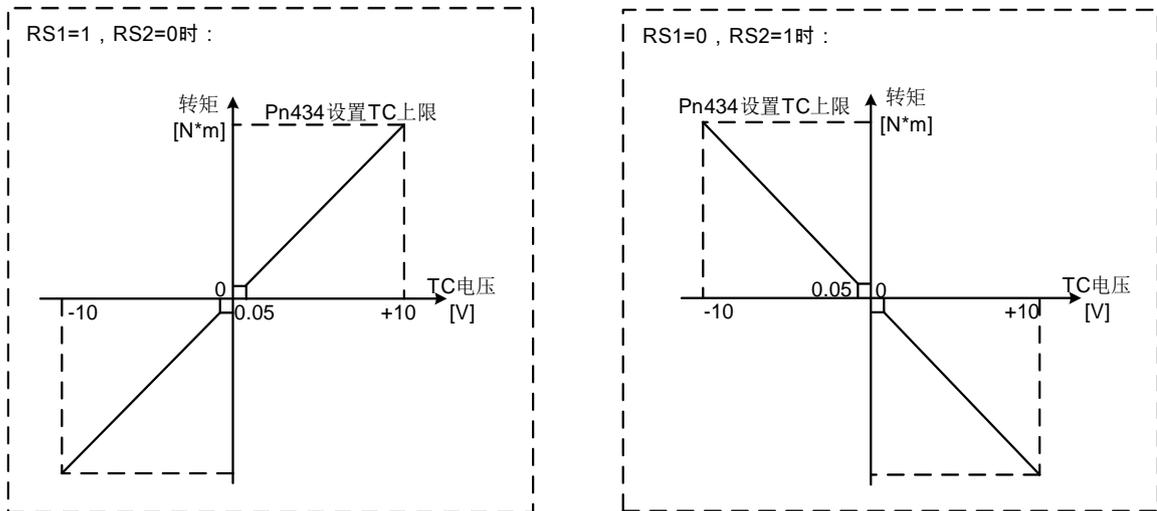
相对一定电压所产生的输出转矩值，由于产品的不同有约 5%的偏差。
