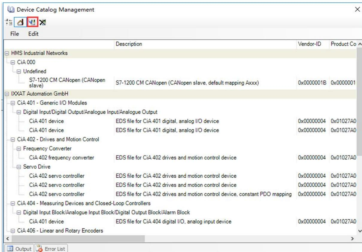
**备注：**导入后查看左下角 Error List 列表，如果显示 0 Errors，则证明 EDS 文件导入成功；如果显示有 Errors，则需根据 Error 信息对应修改 EDS 文件重新导入，如图所示
