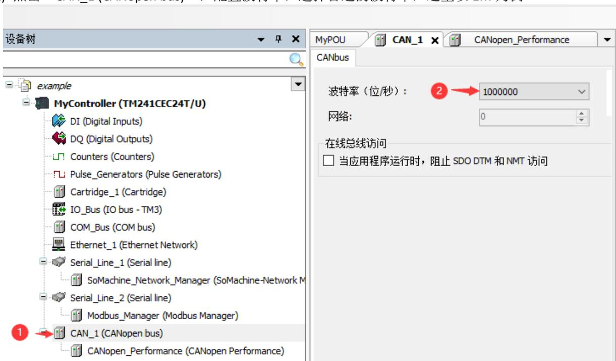
3) 点击“CANopen\_Performance (CANopen Performance)”，启用主站的同步生产，启用主站的生产时间，如图所示：
