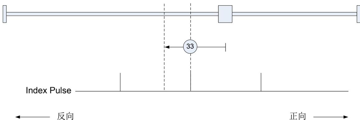
注：索引脉冲信号 (IP) 由伺服内部检测编码器零点位置产生。
