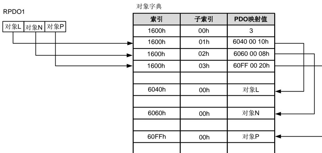
TPDO 的映射方式与 RPDO 一致，传输方向相反。RPDO 按照映射关系解码输入，TPDO 是按照映射关系编码输出。
