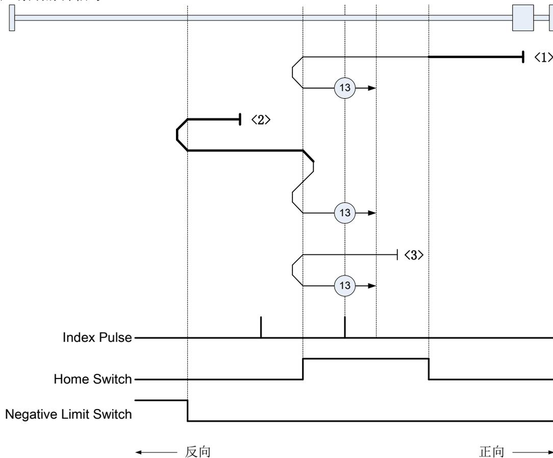
注：索引脉冲信号 (IP) 由伺服内部检测编码器零点位置产生。
