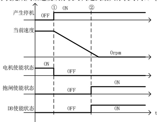
(5) 非抱闸，DB 停机，停机后保持 DB 状态的逻辑时序如图所示。
