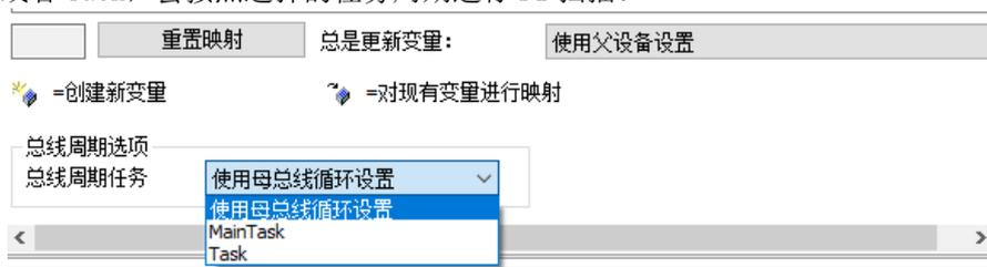
建议使用默认设置，即“使用母总线循环设置”，同时，建议如果并不需要使用 DI，请不要添加此 DI 设备，因为会产生额外的性能消耗。
