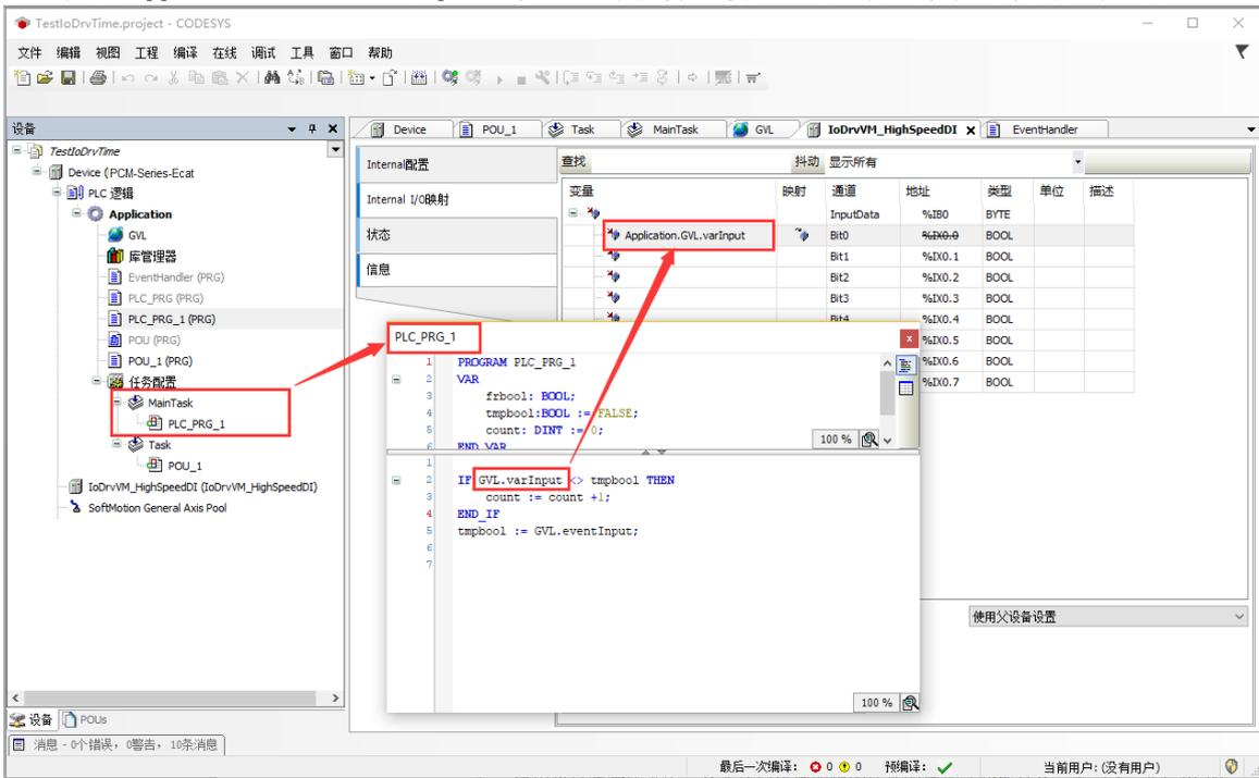
配置完成后，登陆下载工程，即可看到变量随着 DI 输入值变化。
