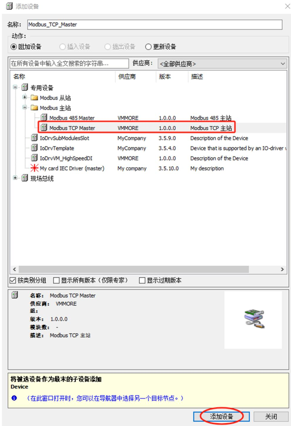
2) 右键单击“Modbus\_TCP\_Master (Modbus TCP Master)”，选择“添加设备”，在打开的对话框中单击 Modbus 设备目录下的“Modbus TCP Device”，单击“添加设备”，添加 Modbus 设备到网络中。
