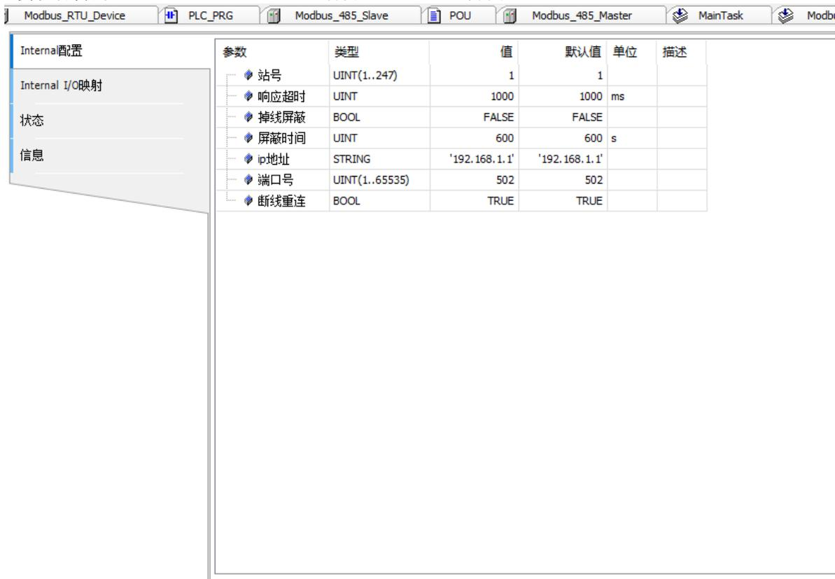
配置 Modbus TCP 设备参数，参数说明如下表所示。
