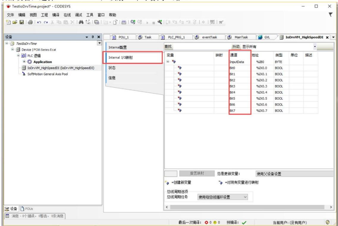
鼠标左键双击其中一路 DI 的变量栏，可以选择要映射的变量，请注意映射的变量只能是 BOOL 类型。也可以将整个 BYTE 类型的输入映射到一个 BYTE 类型的变量。
