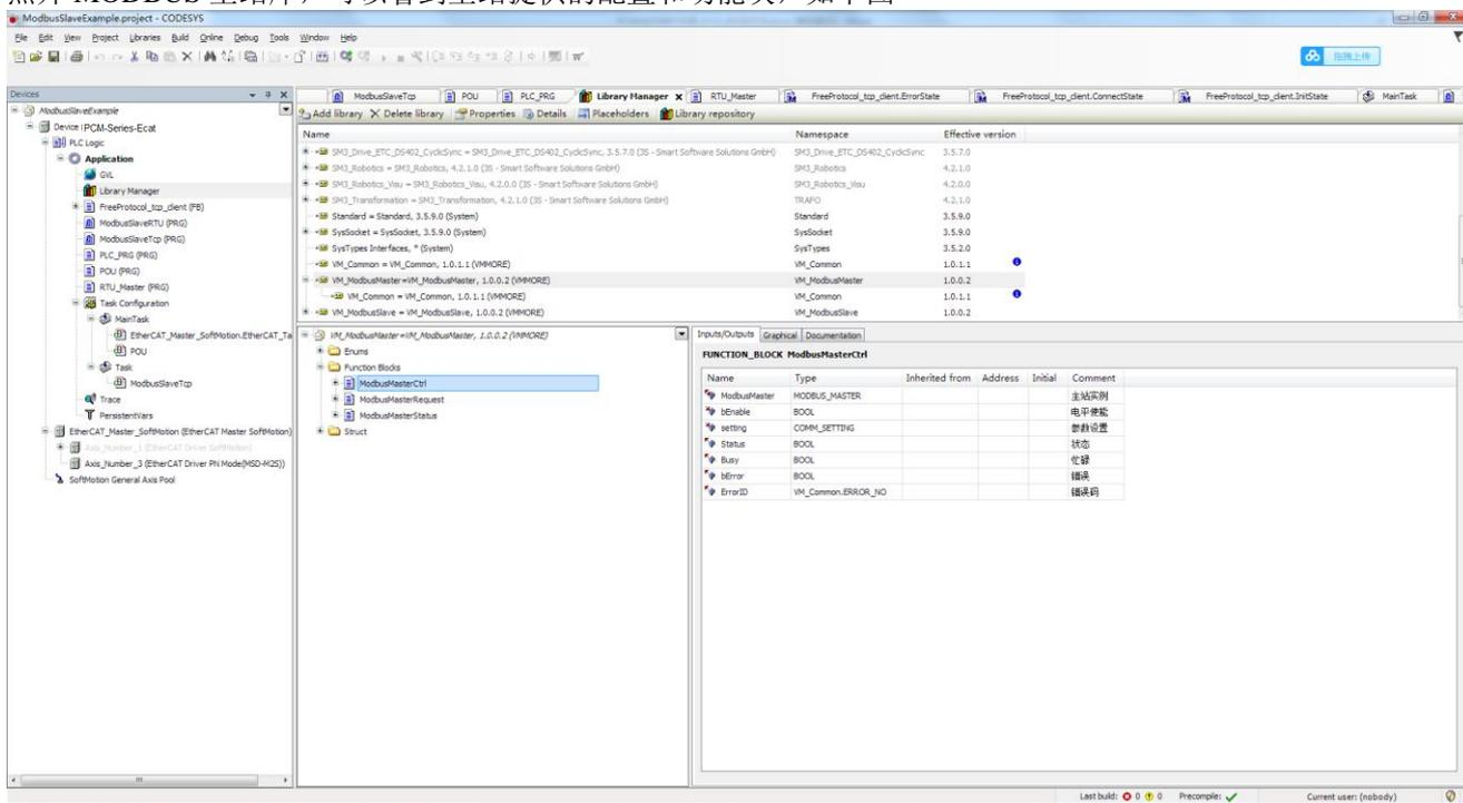
上图中，Function Blocks 文件夹中的是库提供的功能块；Functions 文件夹中包含的是可供调用的函数，包括读写位、字的函数；Struct 文件夹中包含的是通信配置参数。这些功能块和参数都配有中文注释。下面分开介绍。
