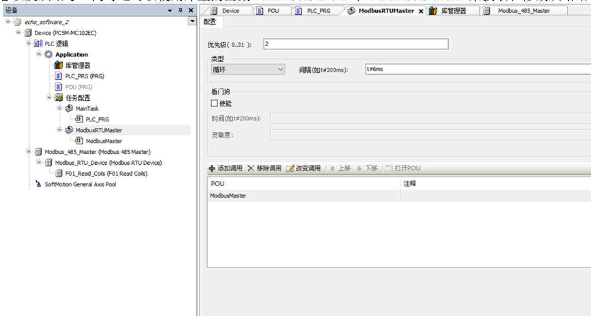
在对 Modbus 主站 I/O 映射进行配置时，可以选择 ModbusRTUMaster 任务作为该 Modbus 主站的总线周期任务。
