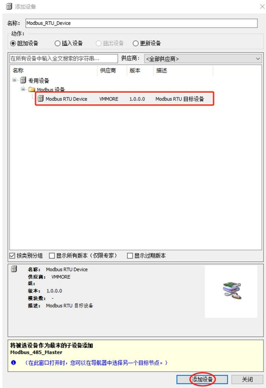
3) 选择“Modbus\_RTU\_Device(Modbus RTU Device)”，单击“添加设备”，可根据功能码选择 Modbus 通道目录下的其中一个，单击“添加设备”，添加一个 Modbus 通道到网络中。
