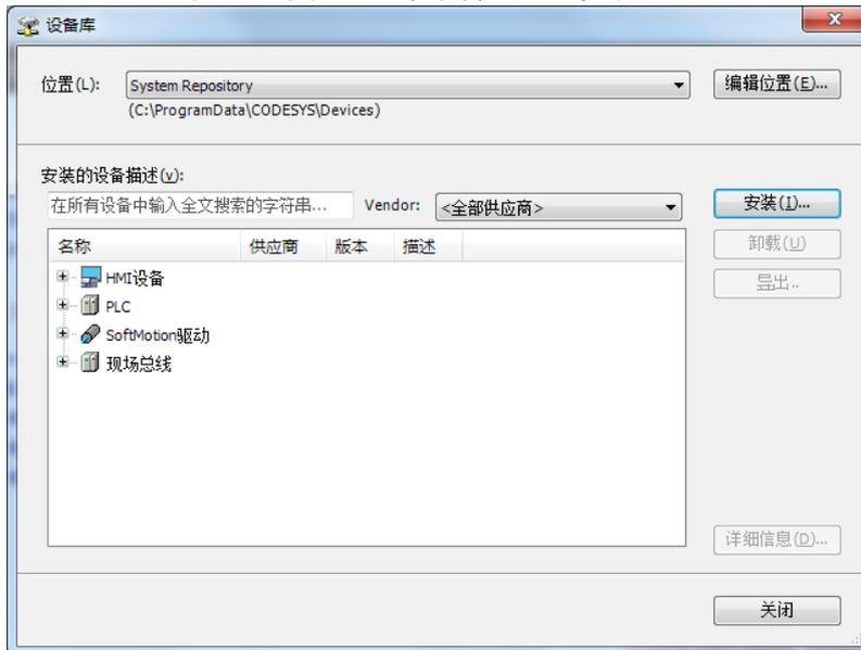
在打开的对话框中选择所需的 PCM-Series-Ecat.devdesc.xml, 点击“打开”按钮确认选项后, 新设备随即添加到“设备库”中的设备目录。
