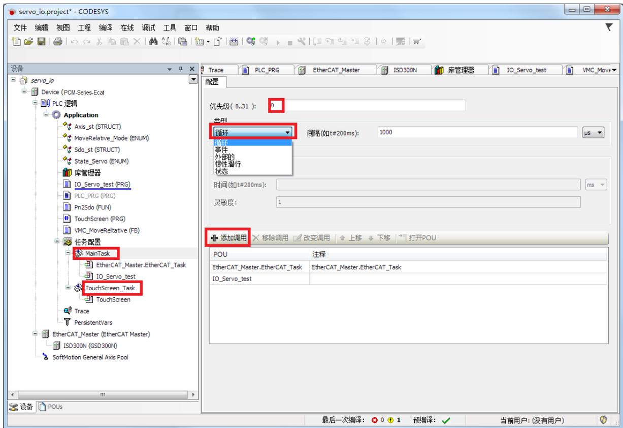
➤ 运动控制器可通过五种扫描方式执行它的任务：循环、事件、外部的、惯性滑行、状态。
