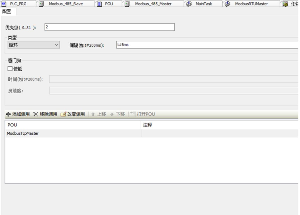
在对 Modbus TCP 主站 I/O 映射进行配置时，可以选择 ModbusTCPMaster 任务作为该 Modbus TCP 主站的总线周期任务。
