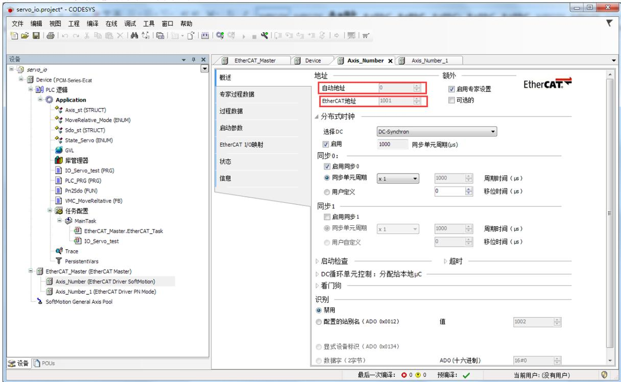
在实际应用中，顺序寻址主要用于启动阶段，主站配置站点地址给各个从站。此后，可以使用与物理位置无关的站点地址来寻址从站。使用顺序寻址机制能自动为从站设定地址。
