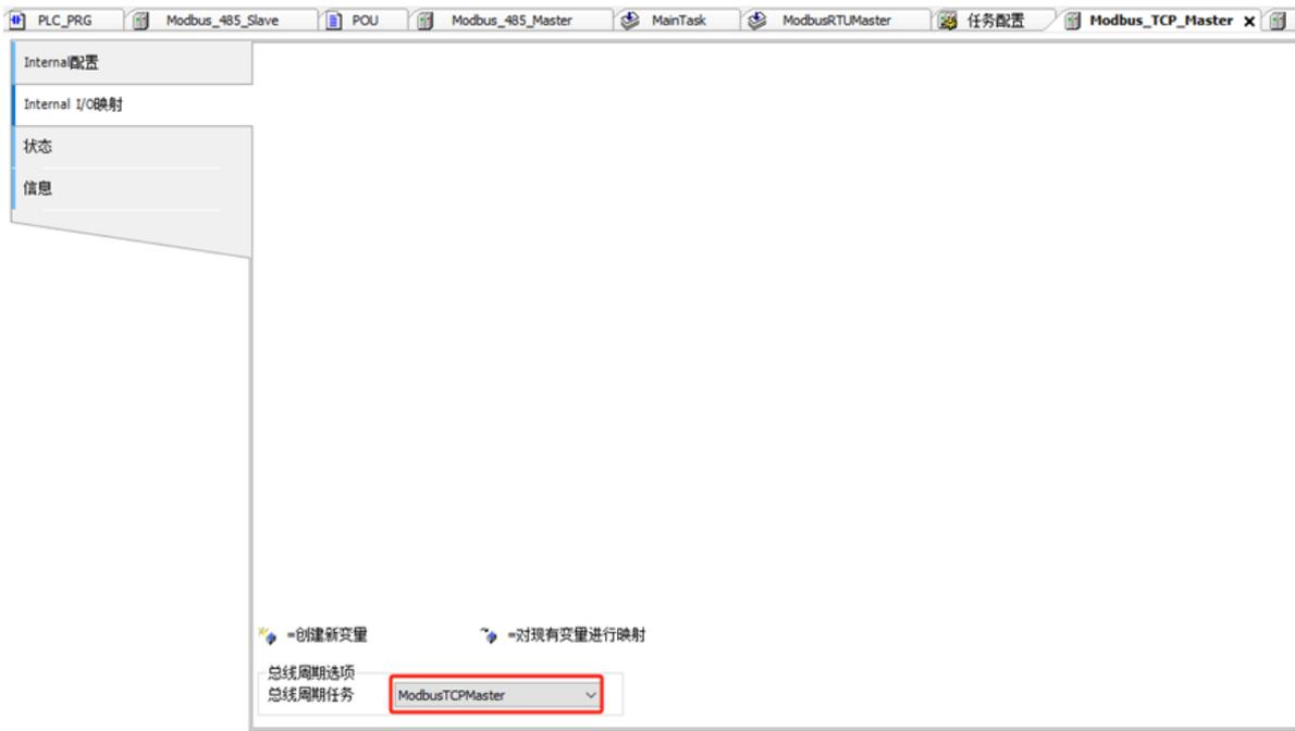
然后对 Modbus 设备 I/O 映射和 Modbus 通道 I/O 映射进行配置，在“总是更新变量”处，可根据情况选择：1、使用父设备设置；2、启用 1（如果未在任何任务中使用，适用总线周期任务）；3、启用 2（总是在总线周期任务中）。
