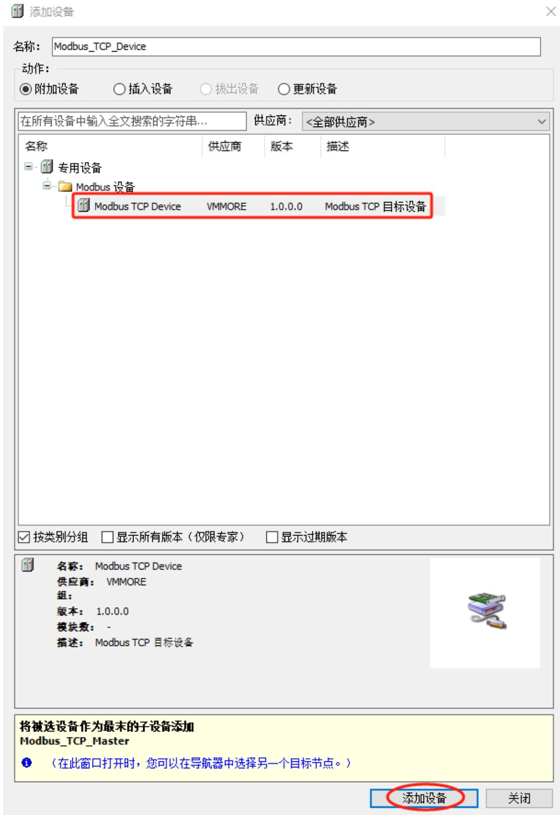
3) 选择“Modbus\_TCP\_Device(Modbus TCP Device)”，单击“添加设备”，可根据功能码选择 Modbus 通道目录下的其中一个，单击“添加设备”，添加一个 Modbus 通道到网络中。
