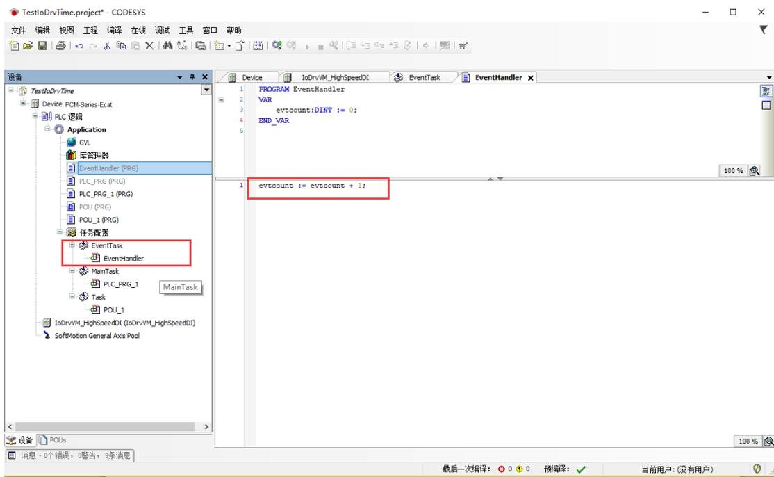
事件配置完成并添加了事件处理程序后，将工程下载到 PC4MR 并运行。如下图，事件被触发了两次。
