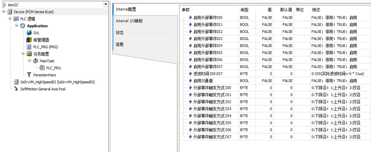
将启用 DI 通道的值改为 TRUE，即可使用 DI映射到程序中的变量。
