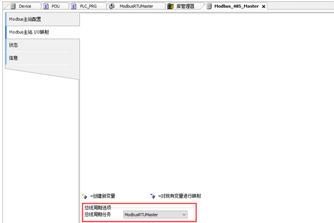
然后对 Modbus 设备 I/O 映射和 Modbus 通道 I/O 映射进行配置，在“总是更新变量”处，可根据情况选择：
