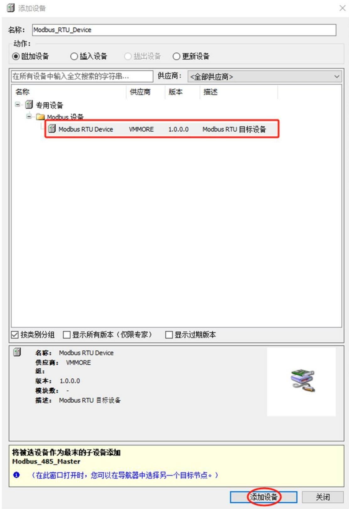
3. 选择“Modbus\_RTU\_Device (Modbus RTU Device)”，单击“添加设备”，可根据功能码选择 Modbus 通道目录下的其中一个，单击“添加设备”，添加一个 Modbus 通道到网络中。
