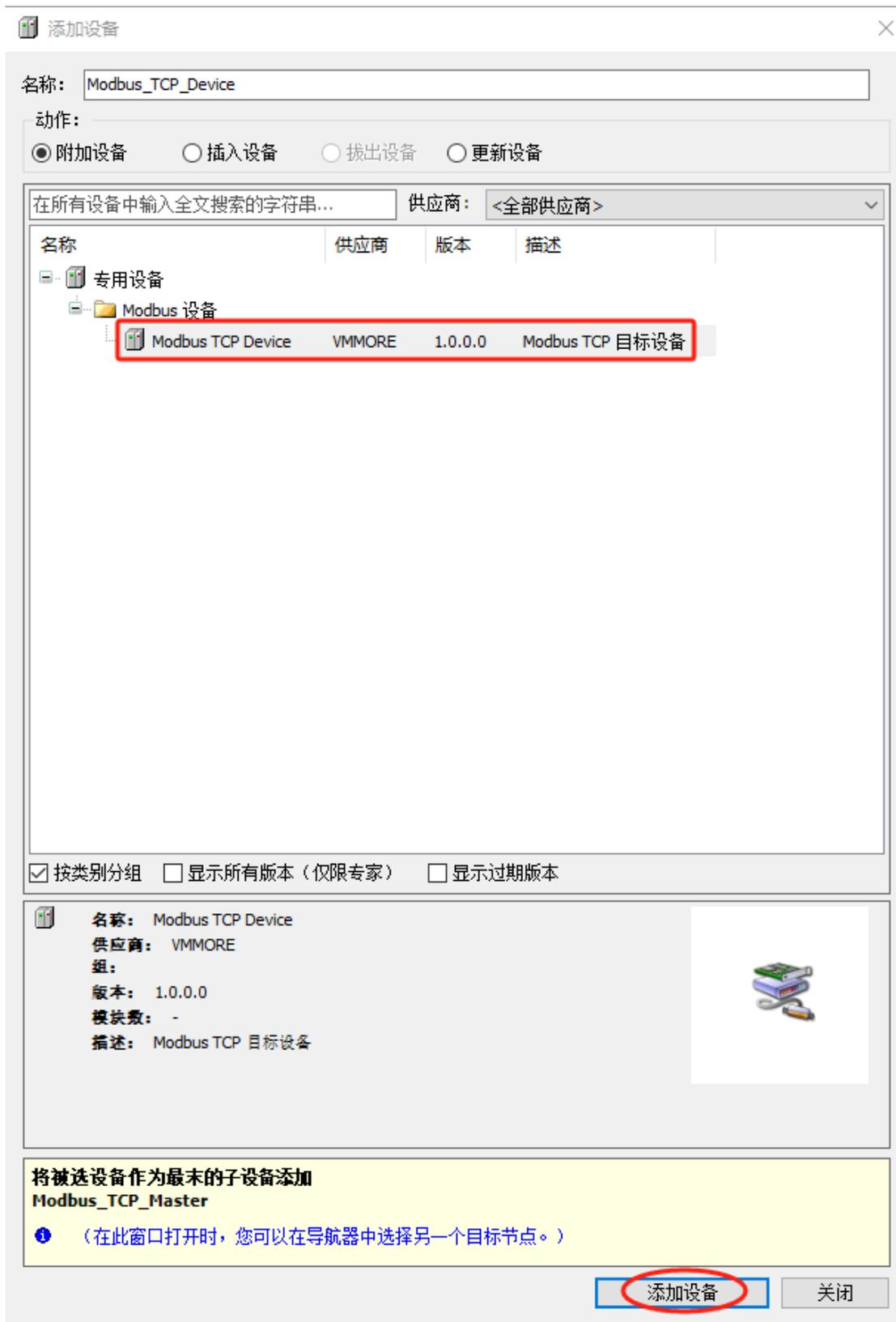
3. 选择“Modbus\_TCP\_Device (Modbus TCP Device)”，单击“添加设备”，可根据功能码选择 Modbus 通道目录下的其中一个，单击“添加设备”，添加一个 Modbus 通道到网络中。
