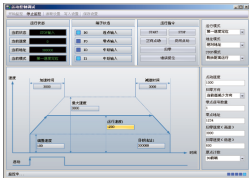
Epro/Eservo可方便完成伺服运动控制设置
